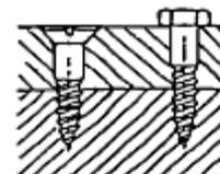
Les vis pour panneaux de bois reconstitués ne présentent pas les caractéristiques déterminantes des vis avec pas de vis à bois. Les vis autoformantes sont semblables au vis autotaraudeuses (n° 7318.1400).
