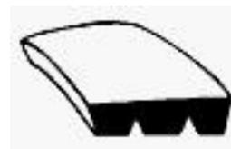
Une courroie striée est une courroie sans fin à surface de traction rainurée dans le sens longitudinal qui entraîne par frottement des gorges de poulies de forme similaire. Les courroies striées sont une sorte de courroie trapézoïdale.
