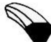
C) Deux profils trapézoïdaux au moins sur la même face (courroies striées)
