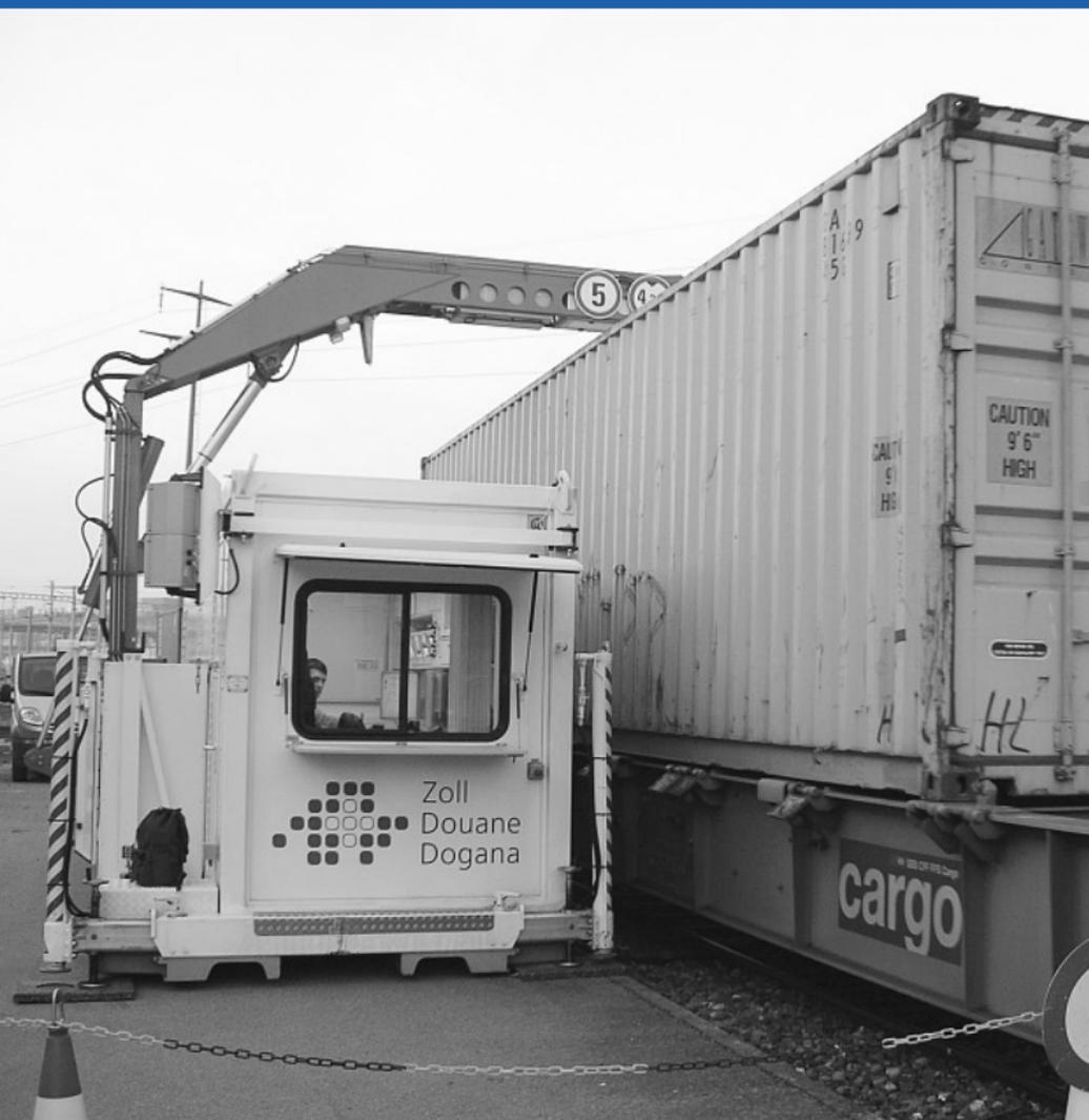
Grâce à ses deux scanners mobiles, la douane peut contrôler les camions aussi rapidement qu'efficacement et diminuer ainsi les temps d'attente à la frontière. Les scanners sont aussi utilisés dans l'espace frontalier, lors de contrôles de poids lourds effectués conjointement avec la police. Enfin, depuis 2006, les wagons de chemin de fer et les conteneurs peuvent aussi être contrôlés par ce moyen.
