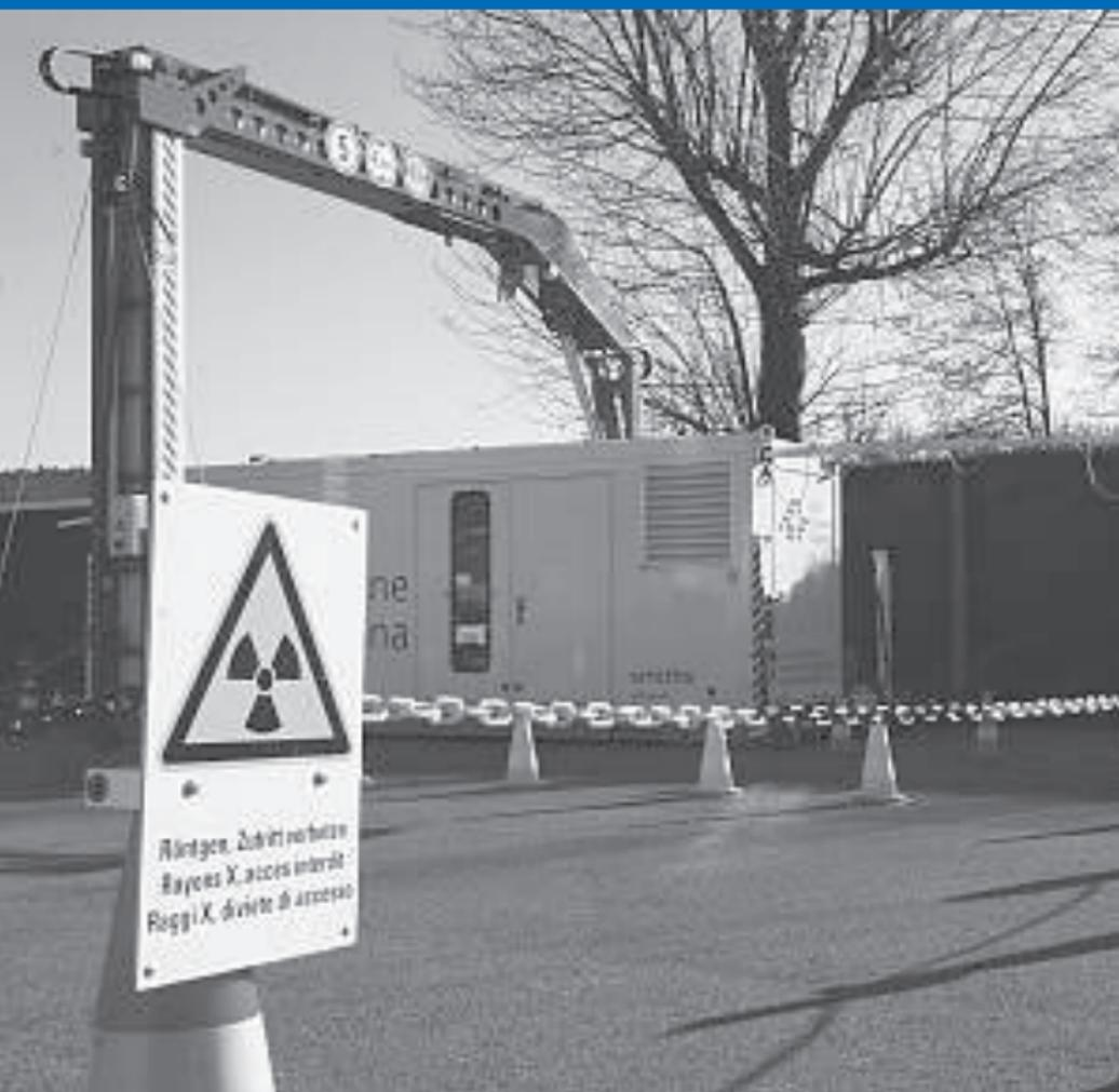
La douane suisse dispose de deux scanners mobiles pour poids lourds. Ces installations à rayons X sont surtout utilisées aux postes frontières fortement mis à contribution. Au lieu de décharger pièce par pièce des tonnes de marchandises, on passe simplement le camion au scanner.
